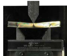
Spannungsoptisches Material unter Biegung ©pasco.com
