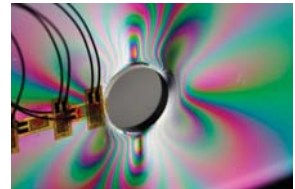
Spannungsoptische Analyse ©teamuv.org
